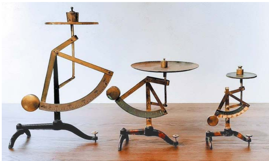
Рис. 1. Весы маятникового типа, предназначенные для взвешивания почтовых отправок
