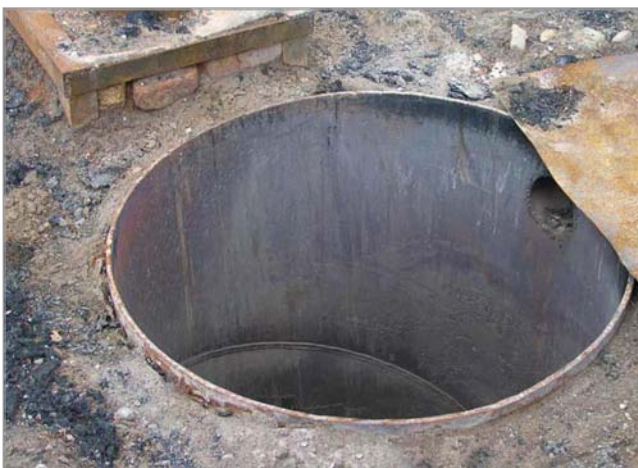
Рис. 4. Шахта для получения дёгтя
