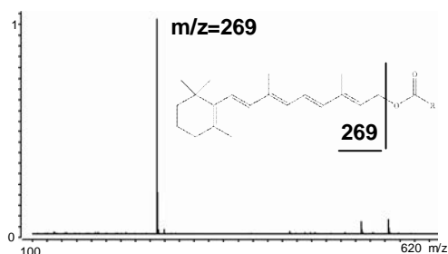
Рис. 7. Масс-спектр РП (ионизация электроспреем) и механизм образования фрагментарного иона.
